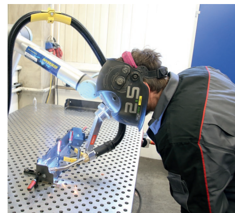
Der Bediener kann ohne aufwendige und teure Schutzeinrichtung direkt an Seite mit dem Lorch Cobot arbeiten.
