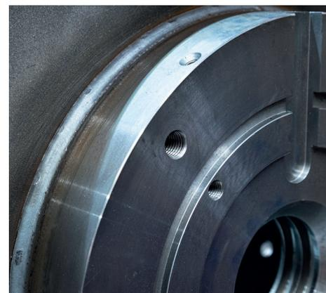
Perfekte Rundnaht: Mit dem Cobot lässt sich der Ring am Turbinen-chassis in bisher nie gekannter Qualität anschweißen – trotz schwierigem Chassis (Manganstahl).
