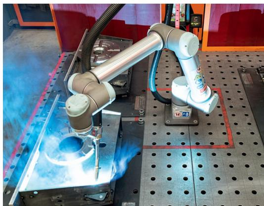
Optimaler Aufbau: Der Cobot in der Mitte zweier Standardarbeitsplätze – in drei Aufspannungen lassen sich so alle Nähte des Turbinengehäuses problemlos schweißen.
