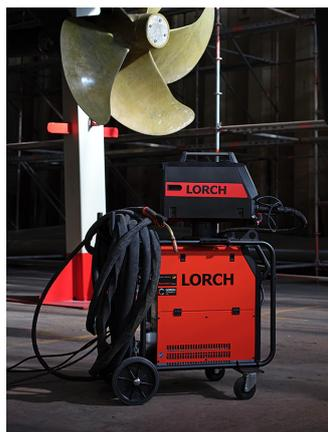
Dank der Heavy-Duty-Ausführung lässt sich die MicorMIG Pulse sicher und problemlos an jede Arbeitsstelle bringen. An den seitlich angebrachten Tragearmen kann zudem das notwendige Schlauchpaket einfach mitgeführt werden.
