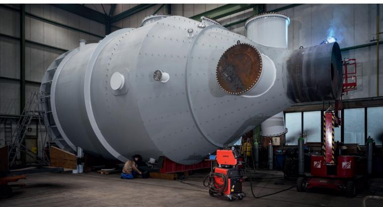
Weit über 1000 Stunden sind nötig, um einen Verdampfer für die Entsalzungsanlage zu schweißen. An die Schweißnähte werden höchste Anforderungen gestellt – jeder T-Stoß wird einzeln geröntgt.
