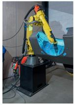
Flexibel: Durch das exakte Zusammenspiel von Roboterarm und Positionierer ist immer ein Schweißen in optimaler Wannenlage möglich.
