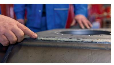
Erstklassige Oberflächen, nahezu spritzerfrei: Dank Robotereinsatz ist die Nacharbeit pro Schweißnaht auf ein absolutes Minimum gesunken.
