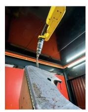
Intelligent: Mithilfe der Seam-Tracking-Funktion findet der Roboter immer den idealen Schweißpfad.
