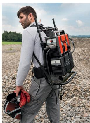
Einfach zu transportieren: Das Duo MicorStick (4,9 kg) und Akkupack (6,0 kg) wiegt zusammen gerade einmal knapp 11 Kilogramm. Weit weniger als so mancher Rucksack auf Reisen.
