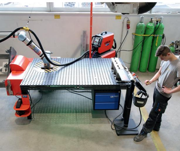
Mit dem neuen Schweißroboter erzielt Habau bei Serienteilen eine massive Zeitersparnis bei gleichzeitiger Entlastung der Schweißer.
