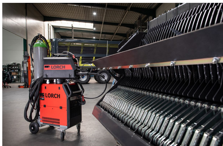
Společnost Fliegl Grünlandtechnik spoléhá výhradně na svařovací techniku od společnosti Lorch: Pro výrobu svařovacích zařízení se používá 10 systémů MicorMIG.
