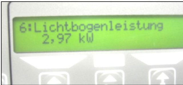
Bild 5: Anzeige der abgegebenen elektrischen Leistung einer Schweißstromquelle der S- und P-Serie von Lorch.
